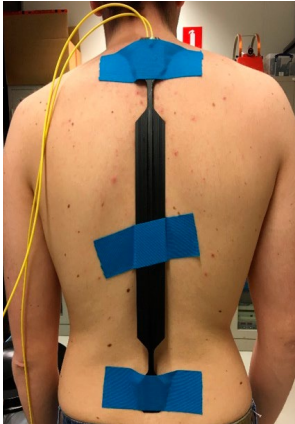
Figuur 20 Fiber optic shape sensing. Met een glasvezel die voorzien is van Fiber Bragg Gratings, wordt een loopbeweging gemeten. In de figuur rechts wordt de vervorming van de meetstrip vergeleken met het Optitrack systeem, waarbij camera's worden gebruikt.
